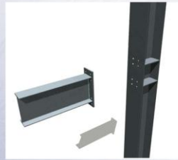
Conexión a momento FR Con placa de extremo extendida a) 4E b) 4ES c) 8ES
