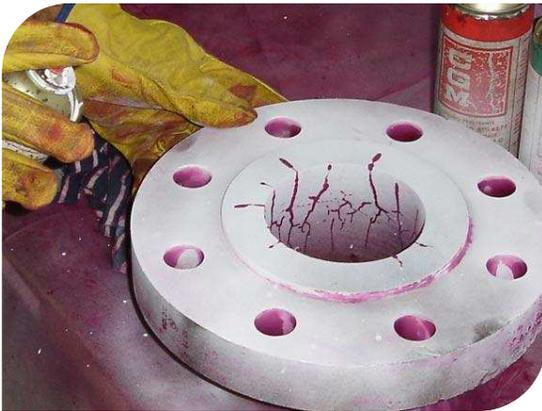
Control de calidad de bridas mediante tintas penetrantes
