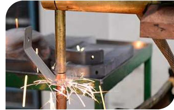
Ejemplo de soldadura por resistencia eléctrica
