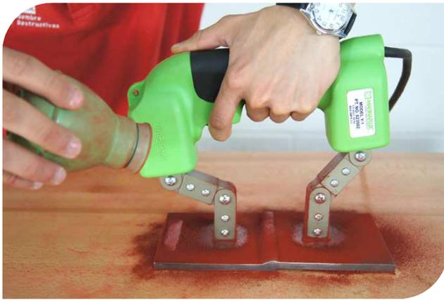
Inspección de probeta soldada mediante partículas magnéticas
